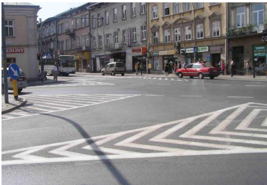
Fot. 9.22. Przykład rozległego skrzyżowania z wyspami malowanymi.
