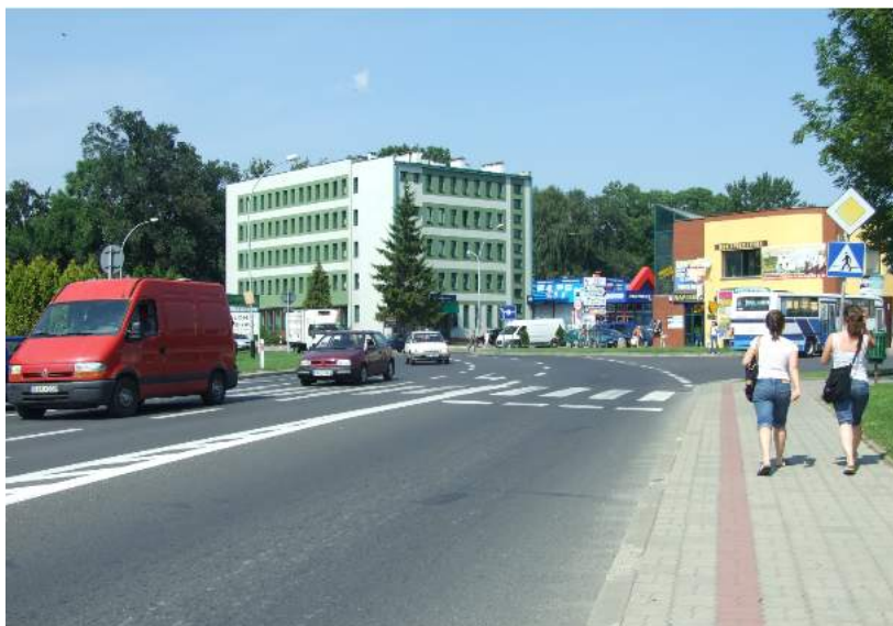
Fot. 9.5. Niekorzystnie usytuowane przejście dla pieszych przez wielopasową jezdnię bez wyspy azylu.
